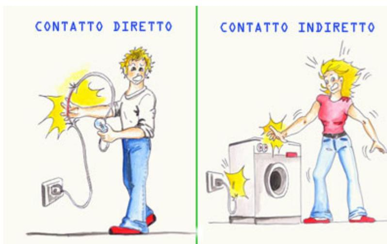
Come si può facilmente capire il contatto indiretto è più insidioso perchè avviene toccando parti che normalmente non dovrebbero essere sotto tensione; per la protezione dai contatti indiretti sono state emanate norme specifiche (cfr. CEI 64-8 art.23-6).
